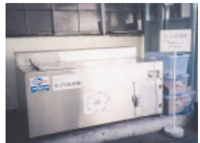
生ゴミ処理機( 青戸工場 )
