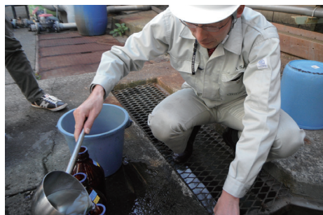
工場排水のサンプリングの様子
