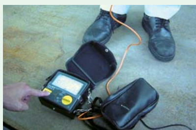
寝屋川センター(作業床・作業靴の導通性確認)
