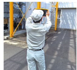
エアー漏れを確認している様子
